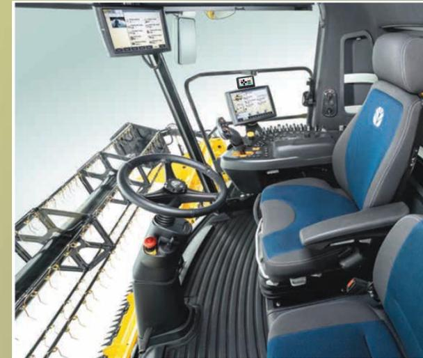
**Ecran tactile plus convivial et intuitif:** accès aux menus directement sous les yeux, visualisation de la position de la machine par indicateurs de positions latéraux et arrière si équipée d'un essieu EHV
